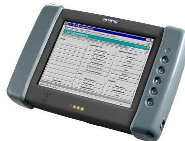
Mit dem mobilen Bedienterminal kann der Lagerleitstand ortsunabhängig über Wireless-LAN genutzt werden.
