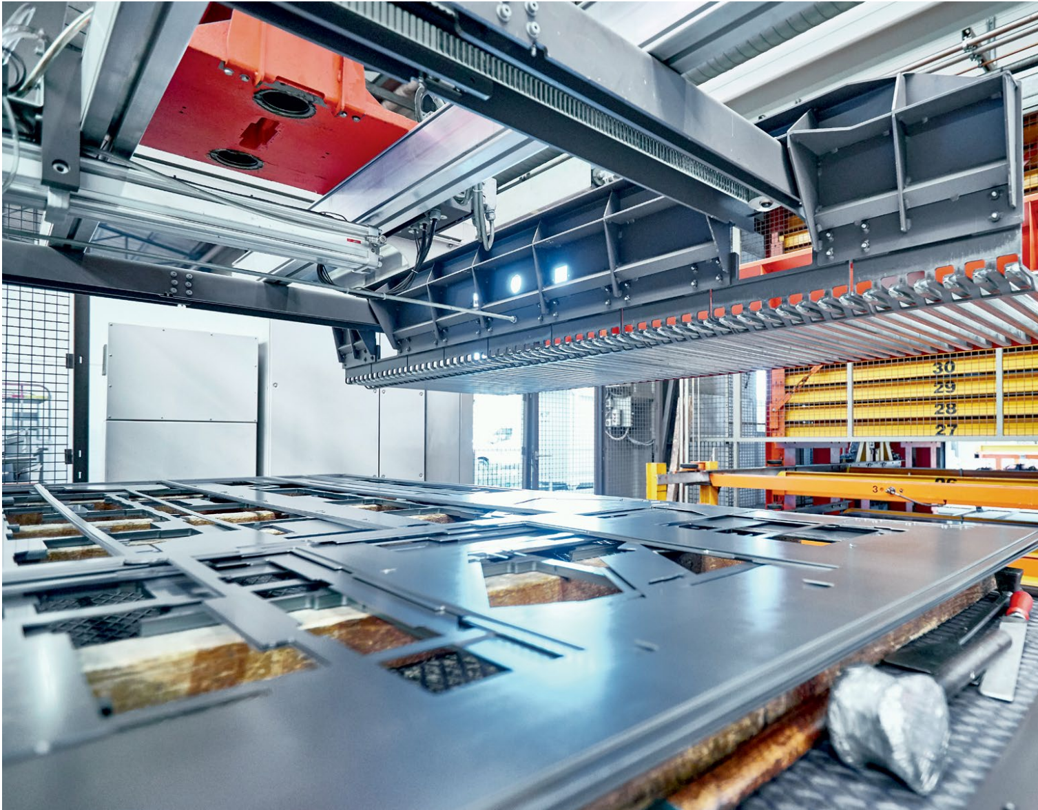
Das Blechteile-Handlinggerät wird ebenfalls über PC-based Control gesteuert.
